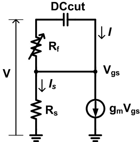
$$V = V_{gs} + \frac{V_{gs}}{R_s} R_f$$
